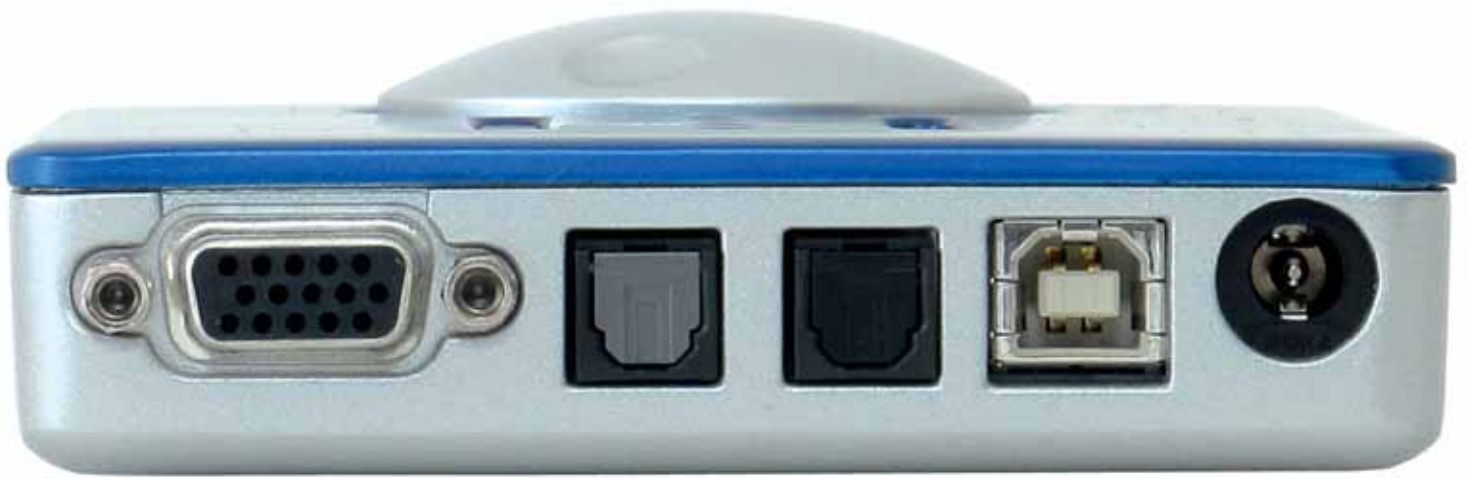
Le connessioni del Babyface: presa di alimentazione esterna, prese ottiche ADAT e S/PDIF, USB, e per il cavo "breakout".
