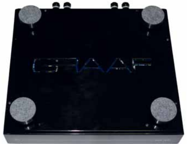
Sul pannello inferiore, al posto delle tradizionali feritoie, il passaggio dell'aria di raffreddamento è favorito da un'asportazione di materiale che ripropone il marchio del costruttore.
