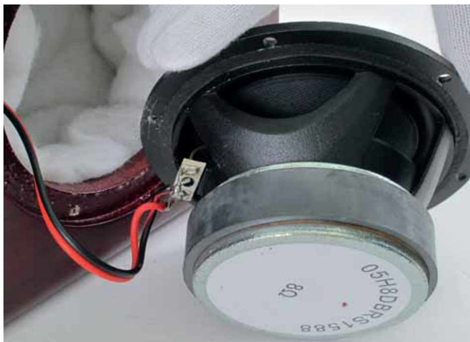
Dettaglio del woofer e del bel cestello in alluminio. I collegamenti, per garantire un miglior contatto, sono saldati direttamente sulla basetta.
