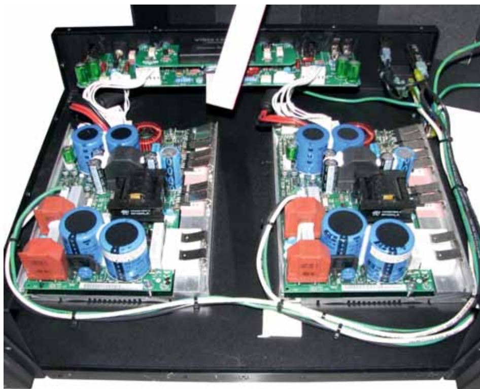
I due moduli di amplificazione, identici, firmati B&O.
