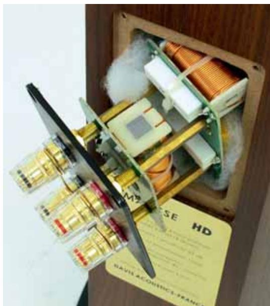
Particolare della piastra posteriore con connettori WBT biwire con ponticelli in rame dorato.
