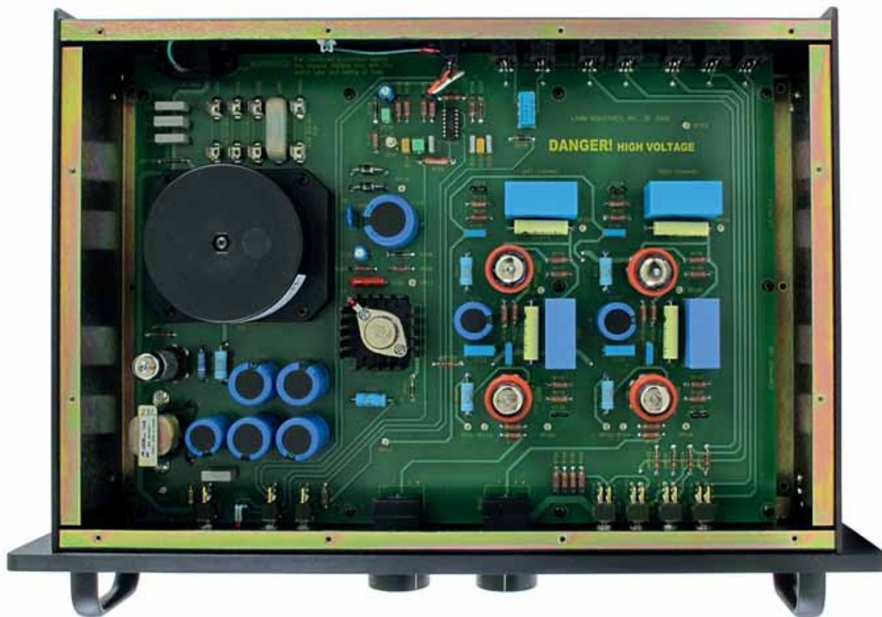
Le due coppie di 12AU7A e di 6DJ8 caratterizzano la circuitazione di questo pre. Totalmente assente il cablabbio, grazie a un'enorme piastra circuitale stampata.
