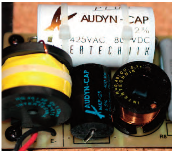
Particolare del crossover del 2° ordine elettrico realizzato con componenti no compromise a bassissima tolleranza
